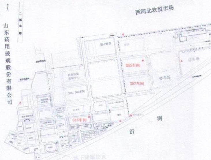
注：“▲” 噪声监测点位；“●” 有组织废气采样点位；“■” 废水监测点位。
